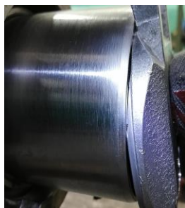
имитация положения хлопушки и расходной трубки при получении вмятин на хлопушке
