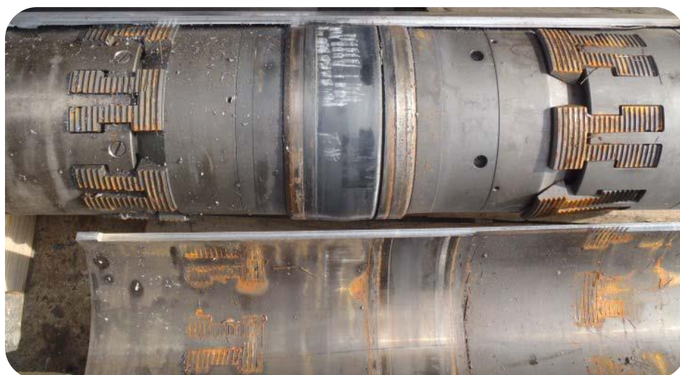
Следы плашек и уплотнительного элемента на колонне
