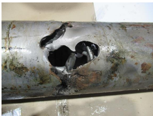
фотографии размытого при ГРП трубного клапана-отсекателя.
