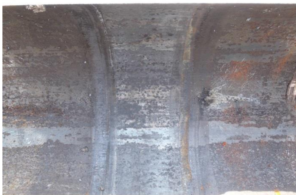
След уплотнительного элемента на обсадной колонне после извлечения
