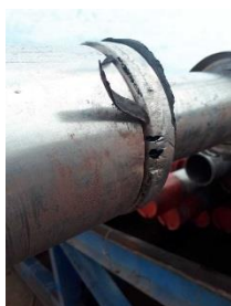
промытые противоэкструзионные кольца системы пакерующего элемента пакера.
