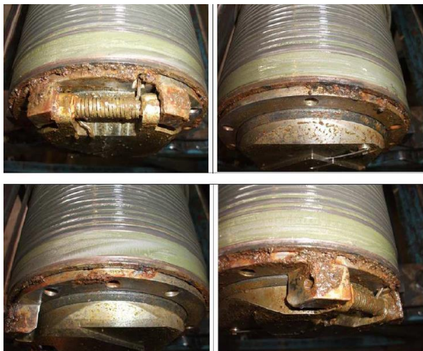
Коррозия есть на ниппеле пружинного отсека. Коррозия, обнаруженная на основании створки клапана, возникла в результате соединения с ниппелем.
